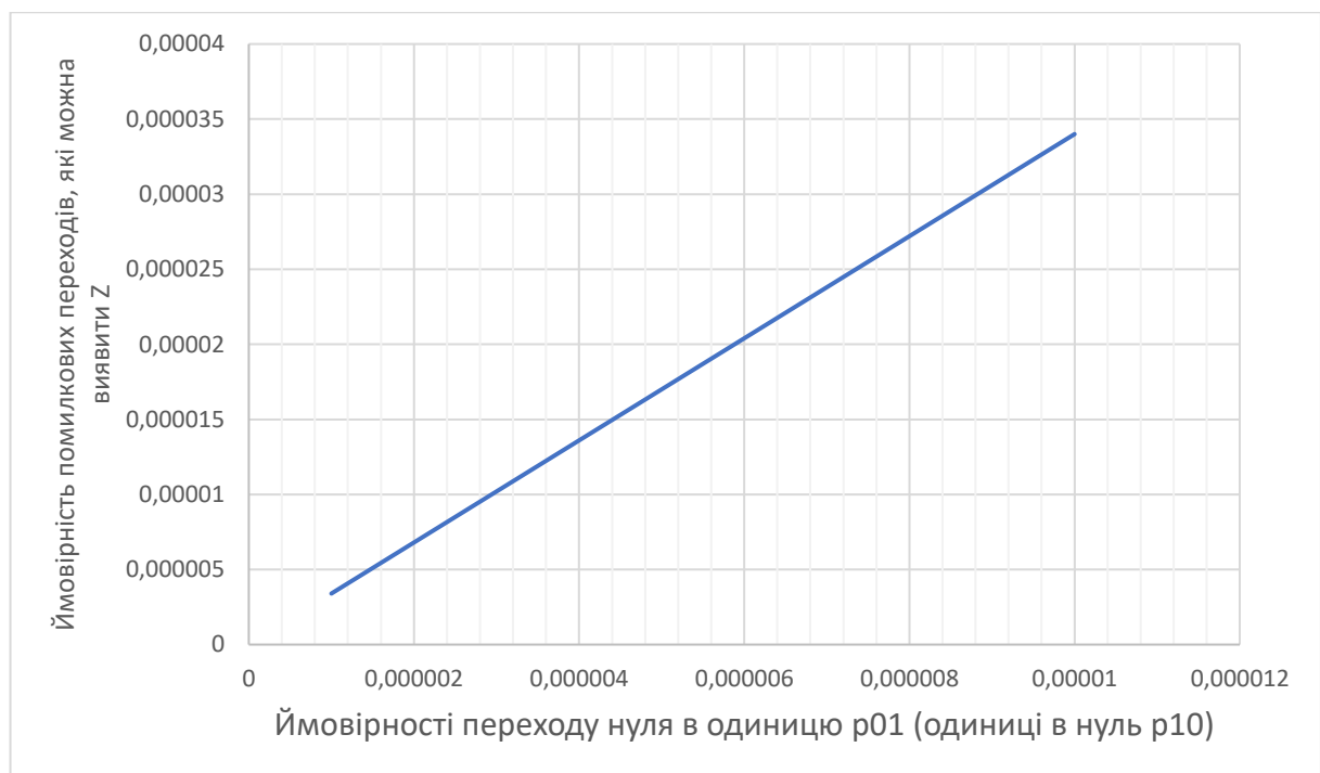
Рисунок 2.3 – Залежність помилкових переходів, які можна виявити від ймовірності переходу нуля в одиницю (одиниці в нуль)
