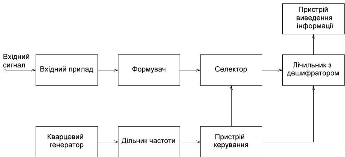
Рисунок 3.2 - Структурна схема цифрового частотоміра
