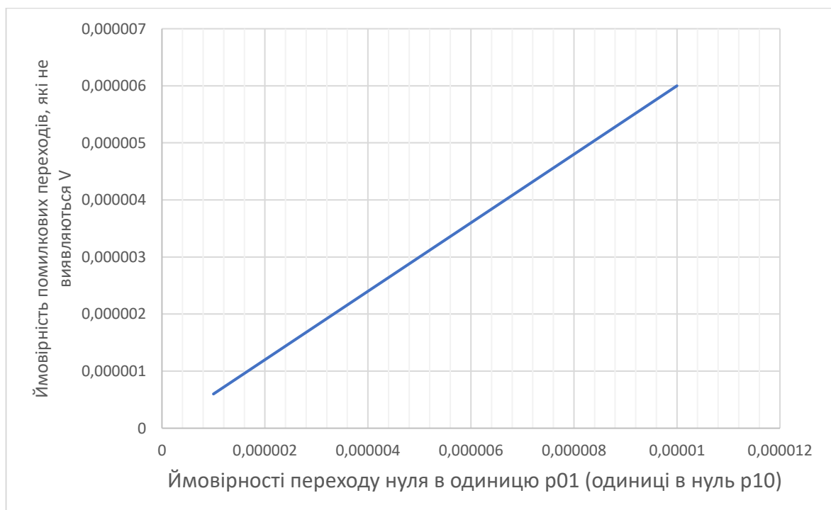
Рисунок 2.2 – Залежність ймовірності помилкових переходів, які не виявляються від ймовірності переходу нуля в одиницю (одиниці в нуль)
