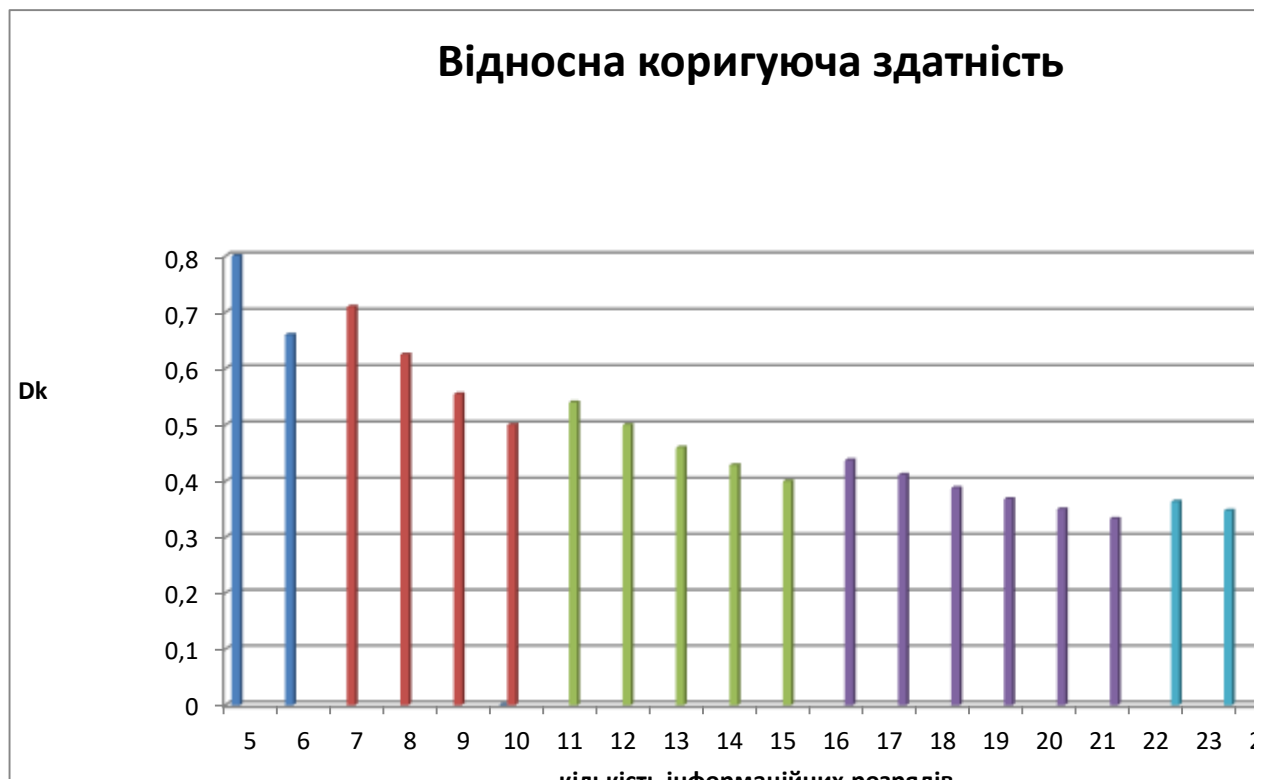
Рисунок 2.2 – Діаграма відносної коригувальної здатності мажоритарних кодів
