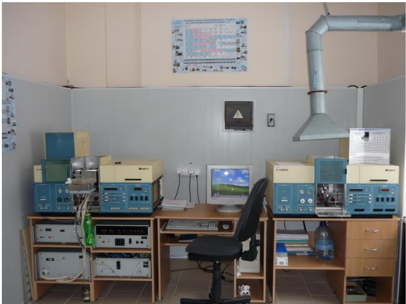
Рисунок 2.1 – Спектрофотометр С115-М1 (кафедра нормальної анатомії СумДУ)
