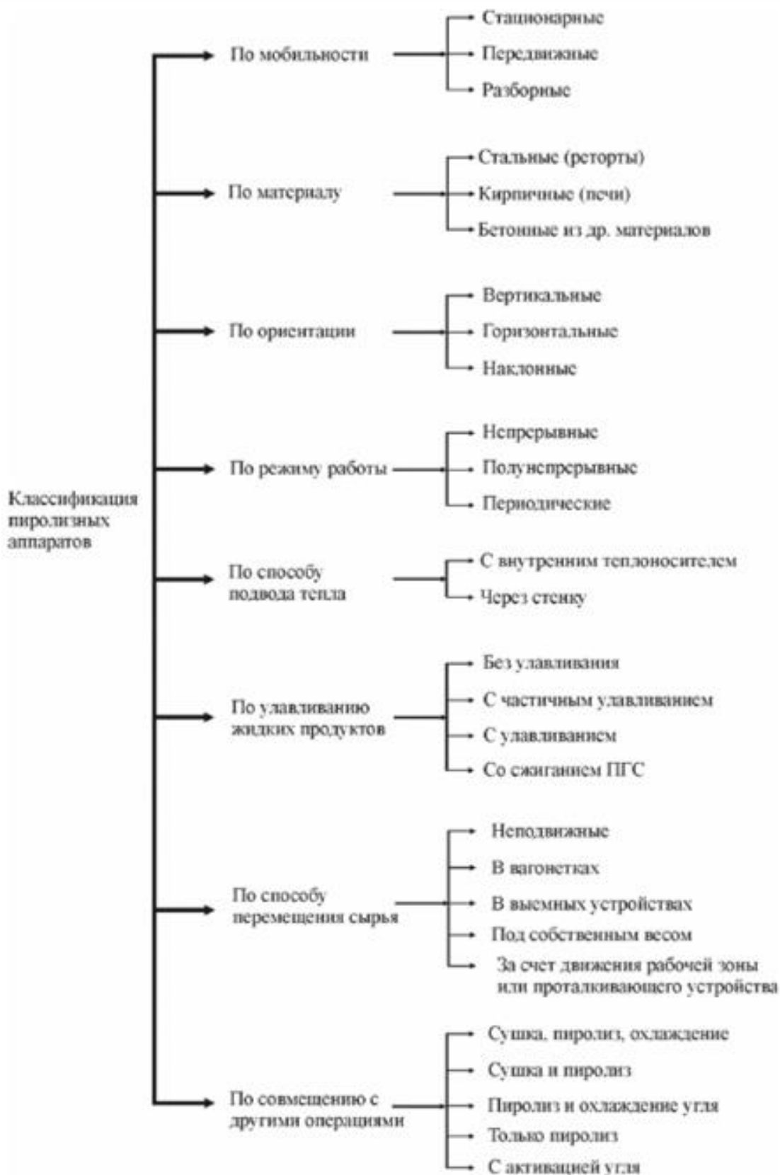
Рисунок 1 - Класифікація піролізних установок
