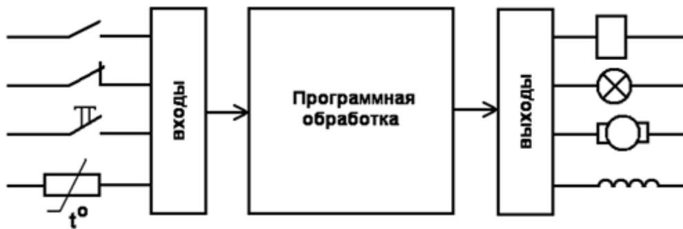
Рисунок 1.8 - Структурна схема програмованого логічного контролера
