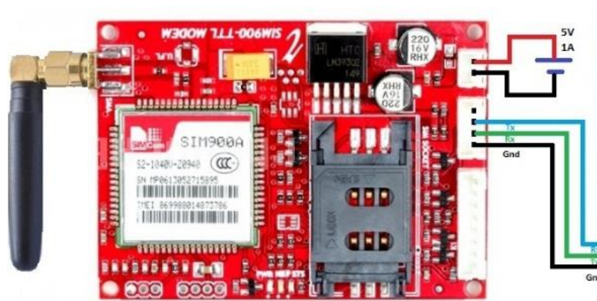
Рисунок 3.10 – Зовнішній вигляд та призначення виводів модуля SIM900.
