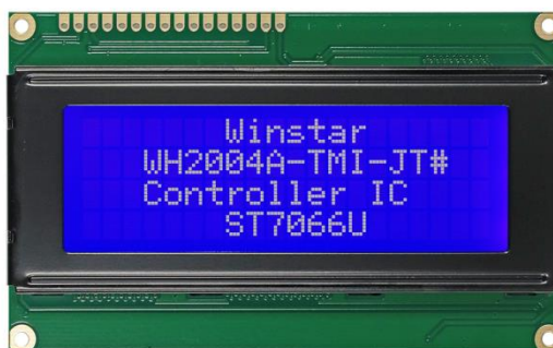
Рисунок 3.6 – Зовнішній вигляд дисплея WH2004
