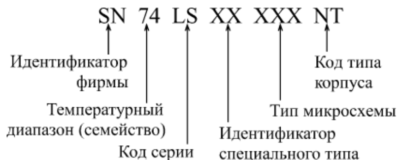
Рисунок 5.1 – Система позначень фірми Texas Instruments
