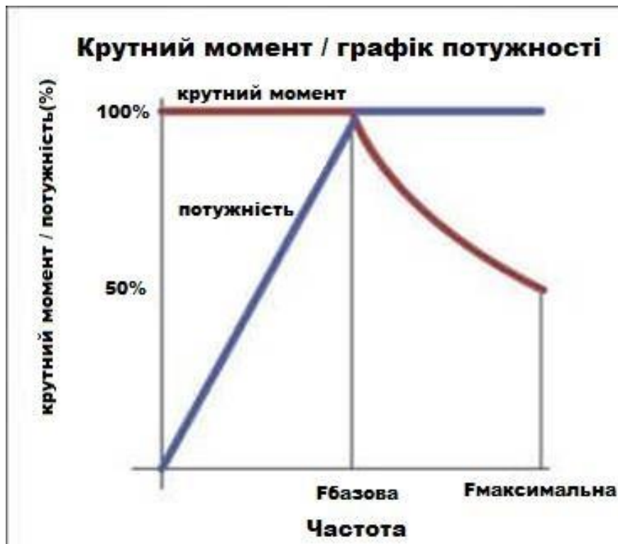
Рисунок 9 – Залежність напруги і моменту на валу двигуна від частоти
