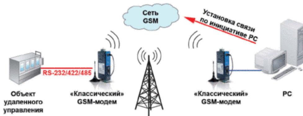
Рисунок 1.8 – "Класична" топологія системи віддаленого управління обладнання по мережах GSM.
