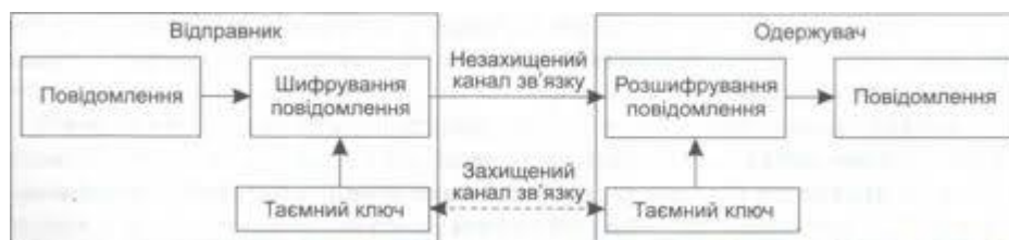
Рисунок 1.1- Структурна схема системи передачі інформації.
