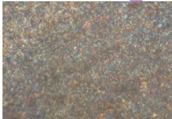
Рисунок 1.1 – Мікроструктура сталі 5ХНМ– після ТЦО x480[5]
