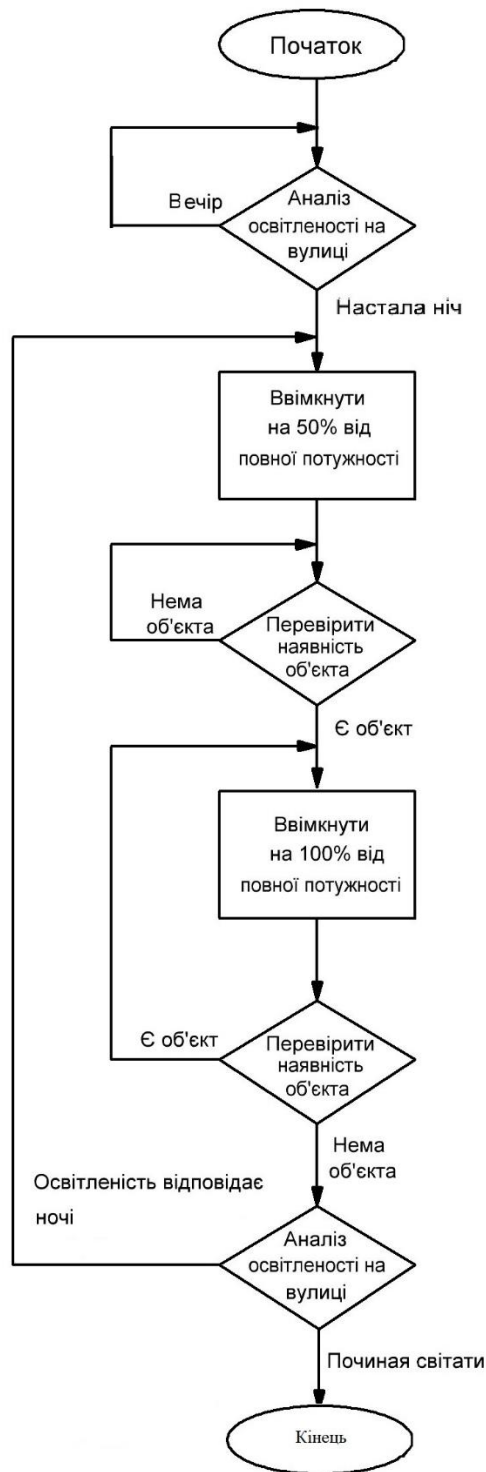
Рисунок 3.3 – Блок-схема роботи режиму “ніч”.
