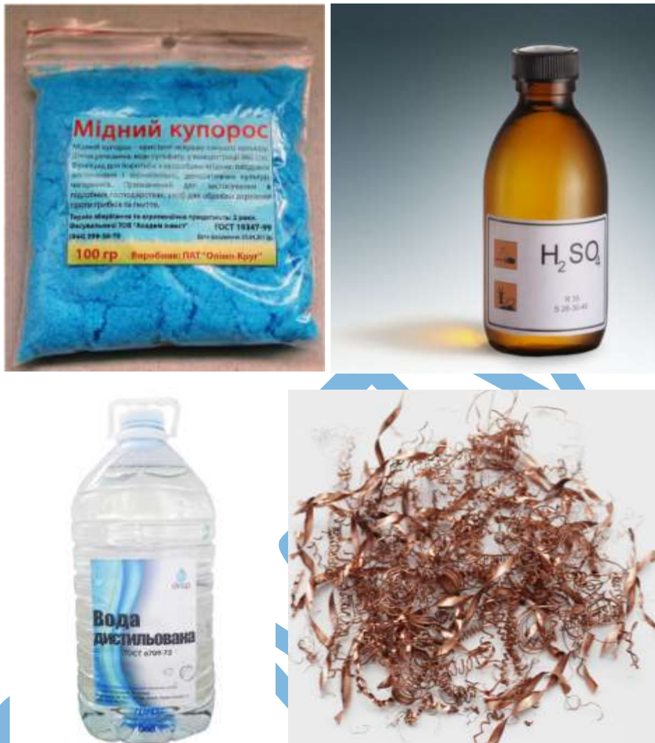
Рисунок 2.8 – Реактиви для випробувань на МКК (метод АМУ) 1 – мідний купорос сірчана кислота; 2 – сірчана кислота; 3 – вода дистильована; 4 – мідна стружка.
