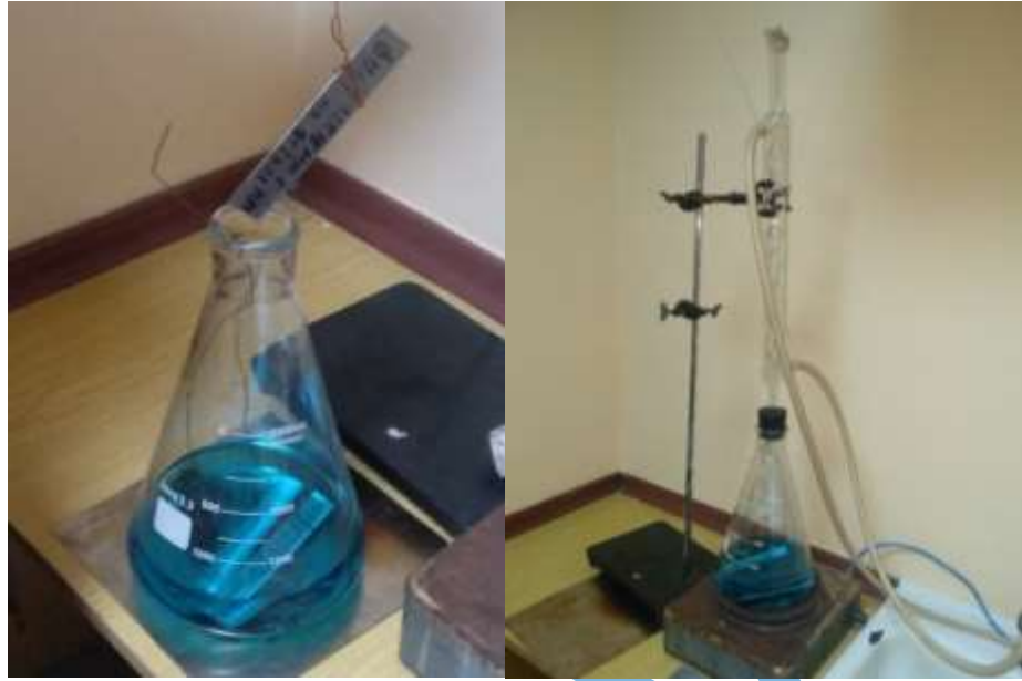
Рисунок 3.2 – Випробування зразків сталі 12X18H10T на стійкість проти міжкристалічної корозії за методом АМУ.
