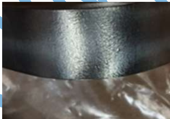
Рисунок 3.3 – Поверхня зразка сталі 12X18H10T після випробування на стійкість проти міжкристалічної корозії за методом АМУ.
