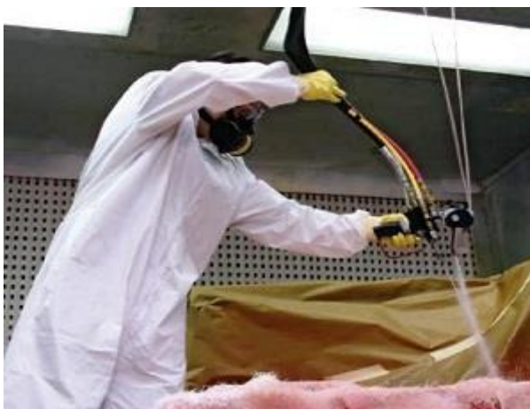
Рисунок 1.9. Формування корпусу човна методом напилення
