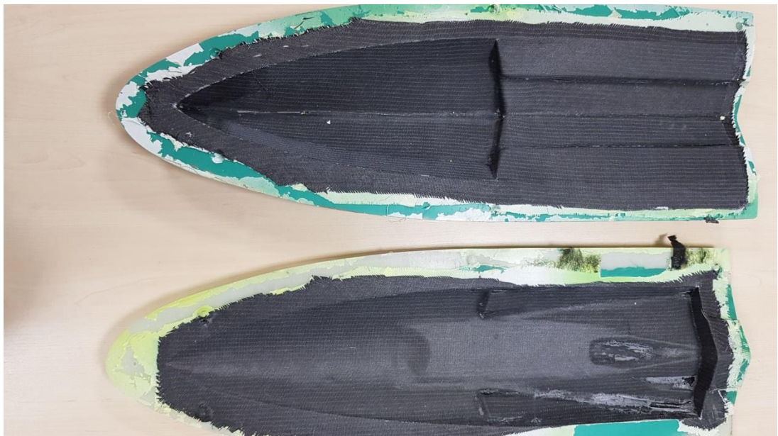
Рисунок 3.3. Матриця з відформованими деталями човна
