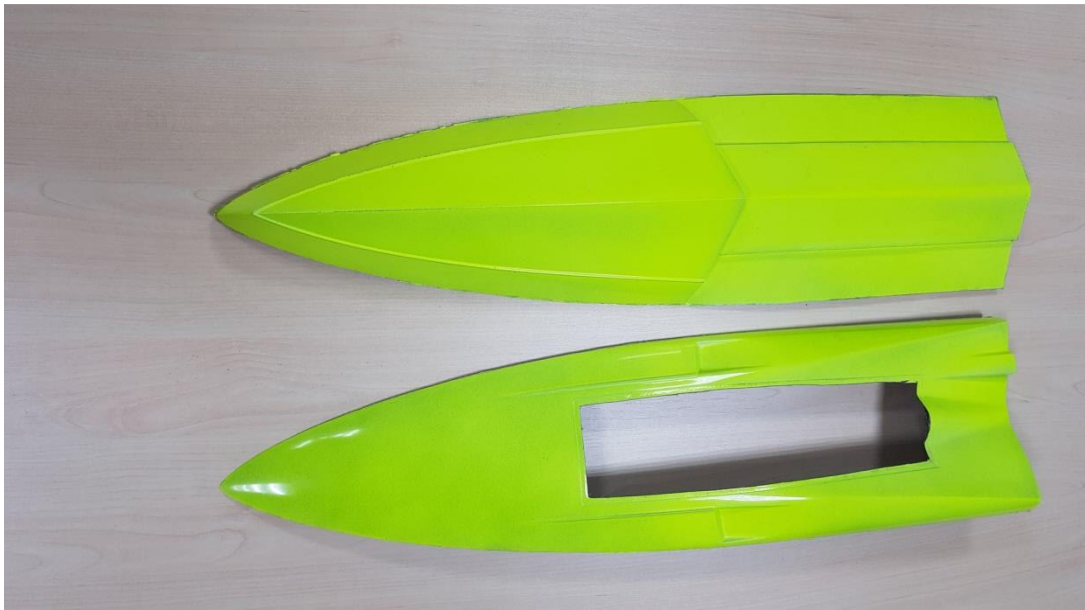
Рисунок 3.4. Деталі човна з віддаленим облоєм
