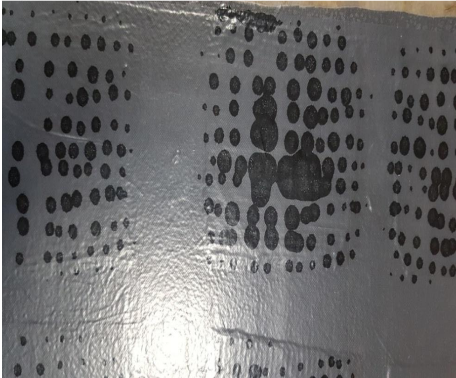
Рисунок 3.12. Поверхня пакету після створення вакууму
