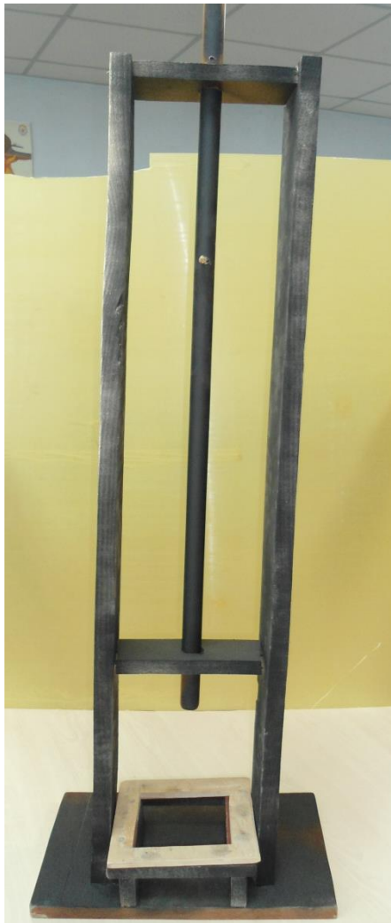
Рисунок 3.13. Копер для ударних випробувань з падаючим навантаженням з напрямних механізмом барабанщика у вигляді циліндричної трубки
