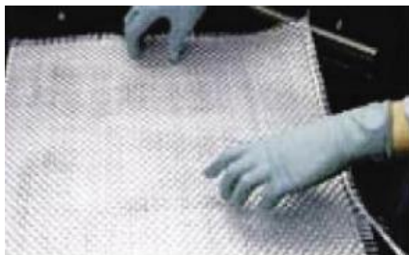
Рисунок 1.3. Укладка склоарміруючого матеріалу
