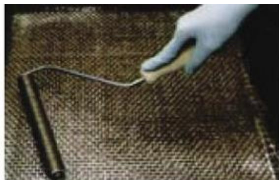
Рисунок 1.3. Укладка склоарміруючого матеріалу
