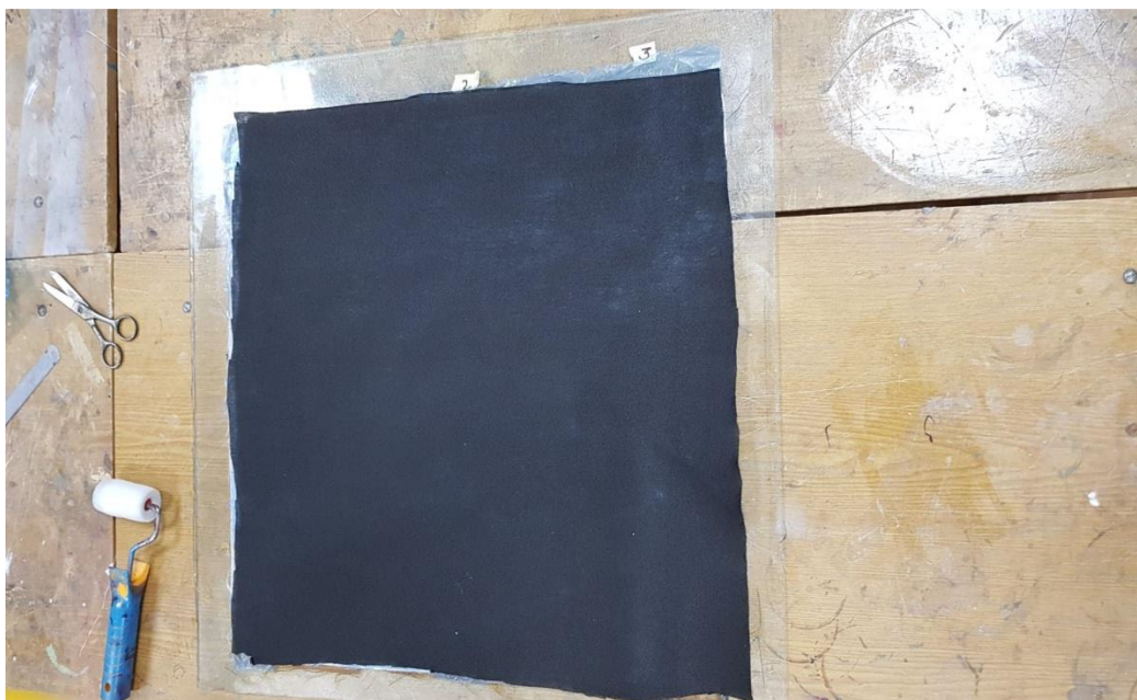
Рисунок 3.9. Укладка вакуумно-провідного шару
