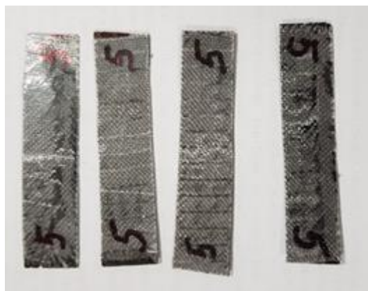
Рисунок 3.15. Зразки для проведення випробувань по визначенню ударної в'язкості ламінату.
