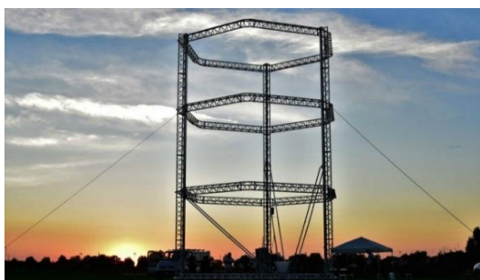
Рисунок 4.3 – 3D-принтер компанії WASP (висота 12 м, діаметр – 6 м) (Загорская, 2015 а)
