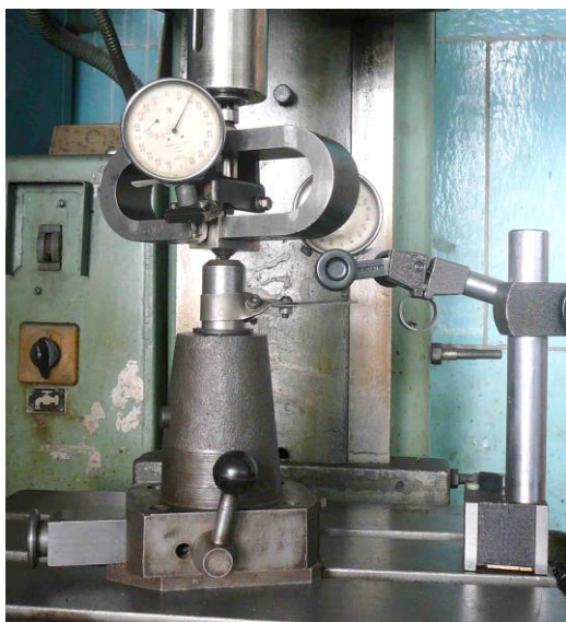
Рисунок 2.11 – Експериментальне дослідження жорсткості допоміжної підвідної опори
