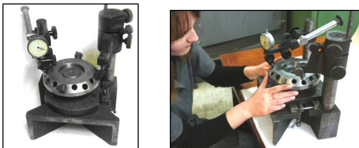
Рисунок 3.4 – Спеціальний пристрій для настроювання та контролю різальних вставок торцевої фрези
