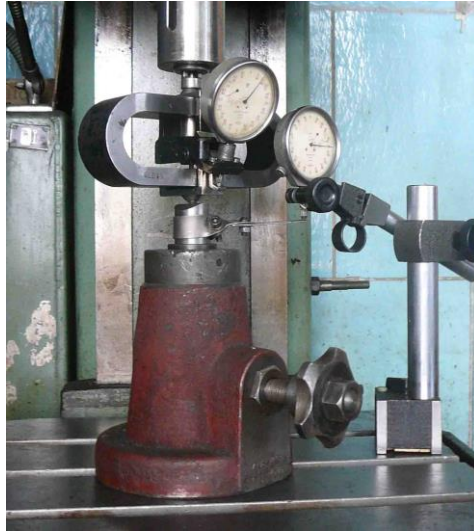
Рисунок 2.9 – Експериментальне дослідження жорсткості допоміжної самоустановлюваної опори
