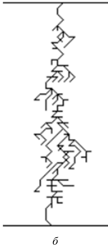
Рисунок 7.17 – Результати моделювання фрактального пробою для конфігурації електродів «площина-площина»
