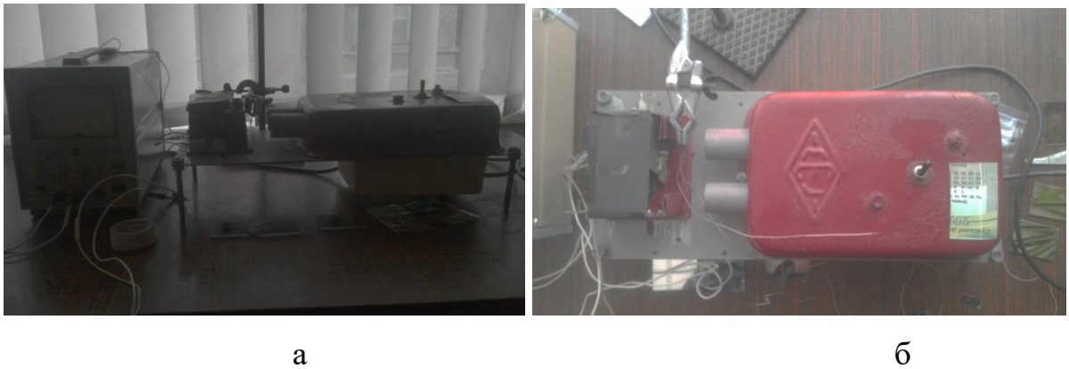
Рис. 2.5 Зовнішній вигляд лабораторної установки для дослідження фотопровідності тонких напівпровідникових плівок: а) вид збоку; б) вид зверху
