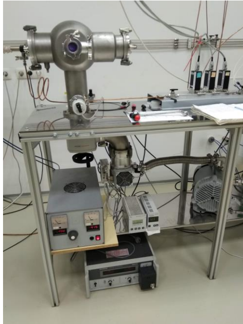
Рисунок 2.1 – Установка для осадження \text{TiO}_2 методом реактивного магнетронного розпилення на постійному струмі
