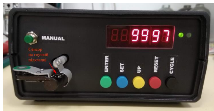
Рисунок 2.7 – Пристрій для вигинань сенсору на гнучкій підкладці
