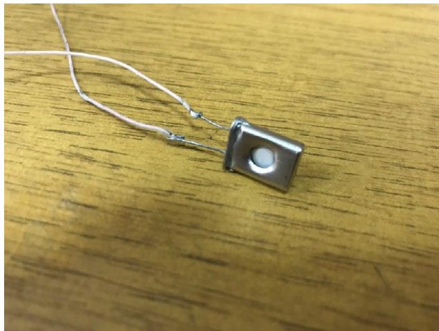
Рис. 2.3.1. – Датчик вимірювання товщини на основі кварцового резонатору
