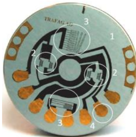
Рисунок 1.6 Чутливий елемент датчика тиску Trafag: 1- мембрана, 2 - 4 тензорезистори, 3 - елементи з контуру компенсації температури, 4 - провідні а також позолочені контактні площадки
