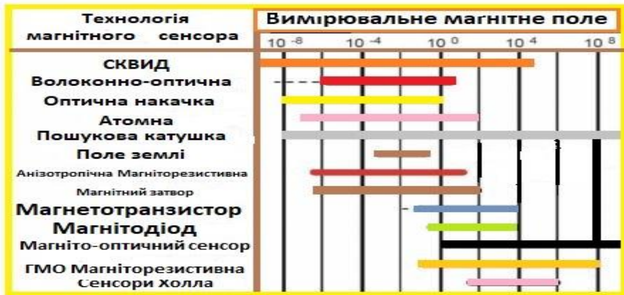
Рисунок 1.4 – Чутливість різних магніторезистивних датчиків.
