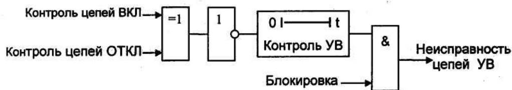
Малюнок 6.13 Функціональна схема блоку контролю несправності ланцюгів управління вимикачем
