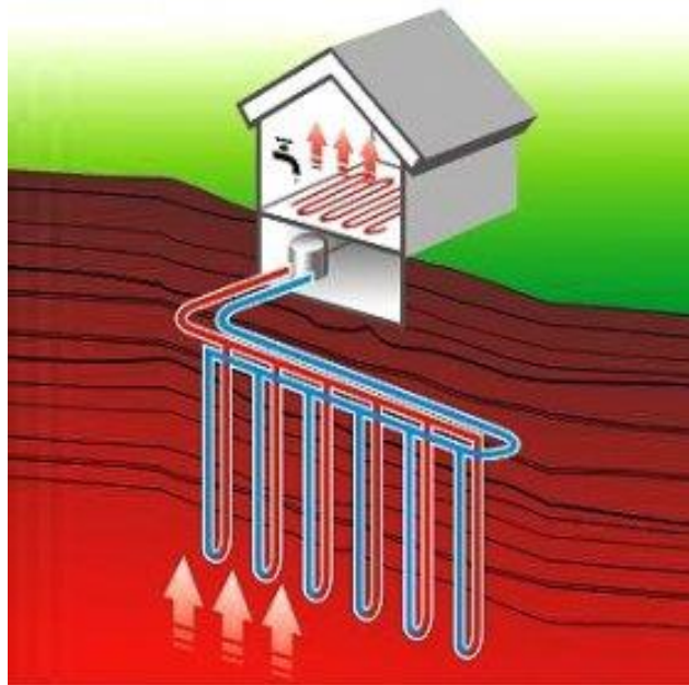
Рисунок 2.2 – Принципова схема розміщення теплового насосу
