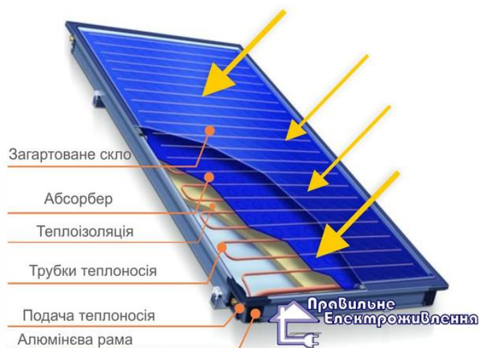
Рисунок 3.1 – Плоский сонячний колектор [13]
