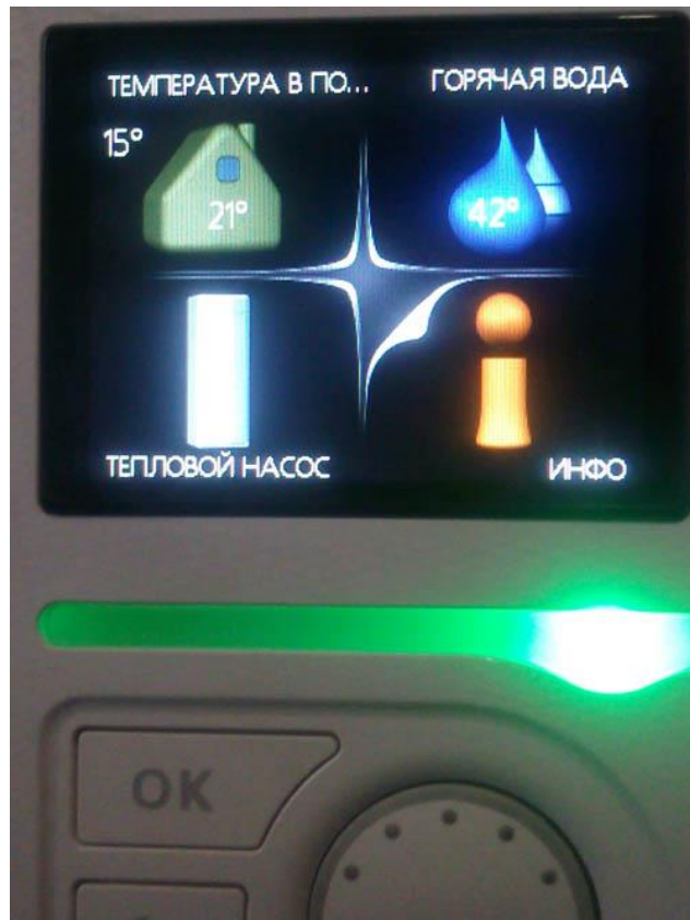
Рисунок 3.4 – Інтерфейс блоку системою опалення [16]
