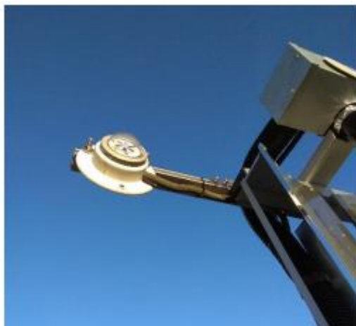
Рис. 4.42 - Спосіб установки піранометра
