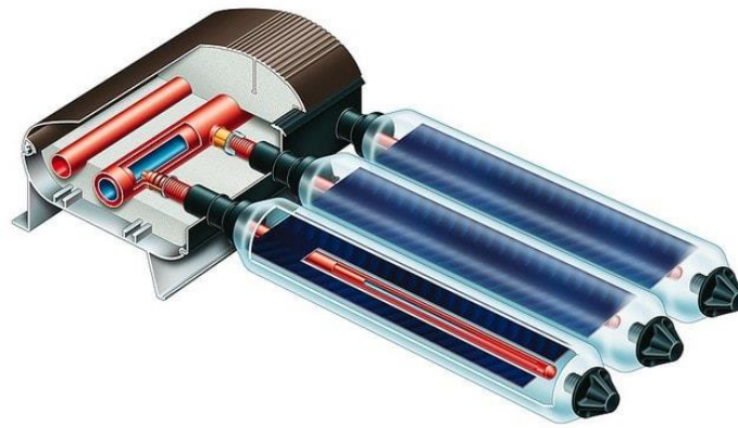
Рис. 2.16 - Конструкція вакуум-трубного колектора [spb-artstroy.ru]
