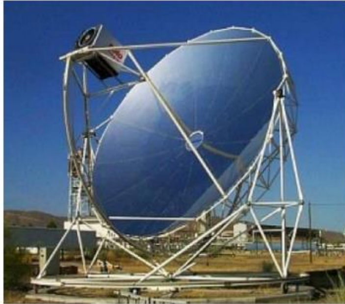
Рис. 2.21 - Дисконий параболічний концентратор [e-education.psu.edu]
