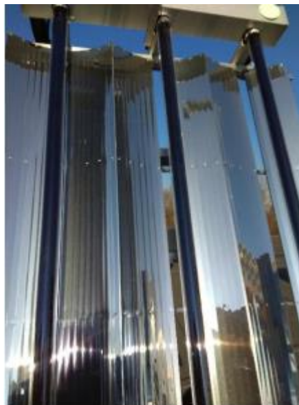
Рис. 4.35 - Поверхня навісу з поглинальними трубами
