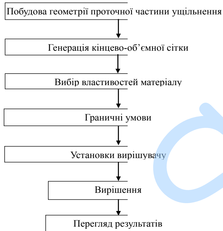
Рисунок 2.1 – Схема розрахунку в програмному комплексі ANSYS MECHANICAL
