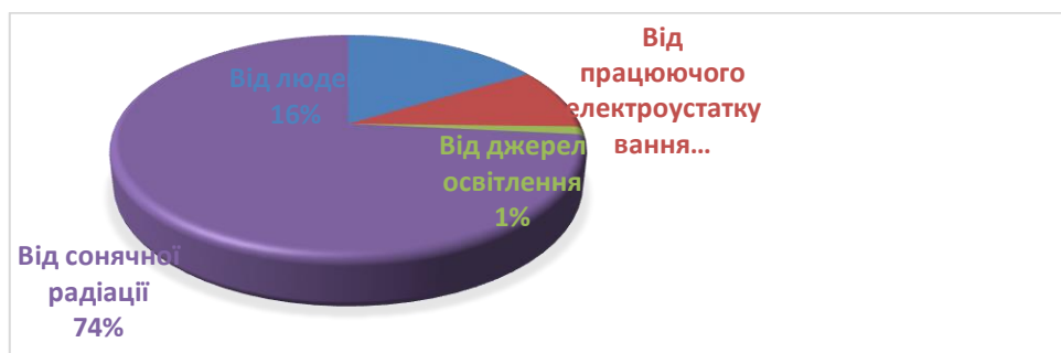
Рисунок 2.4 – Розподіл теплонадходжень в корпусі Б
