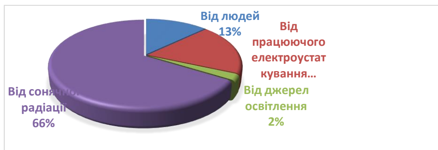
Рисунок 2.3 – Розподіл теплонадходжень в корпусі А
