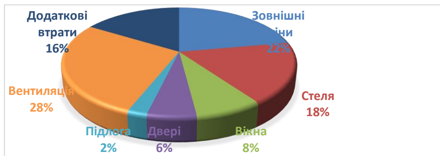
Рисунок 2.2 – Розподіл тепловтрат корпусу Б
