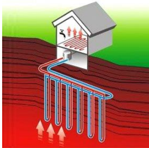
Рисунок 2.3 – Принципова схема розміщення теплового насосу
