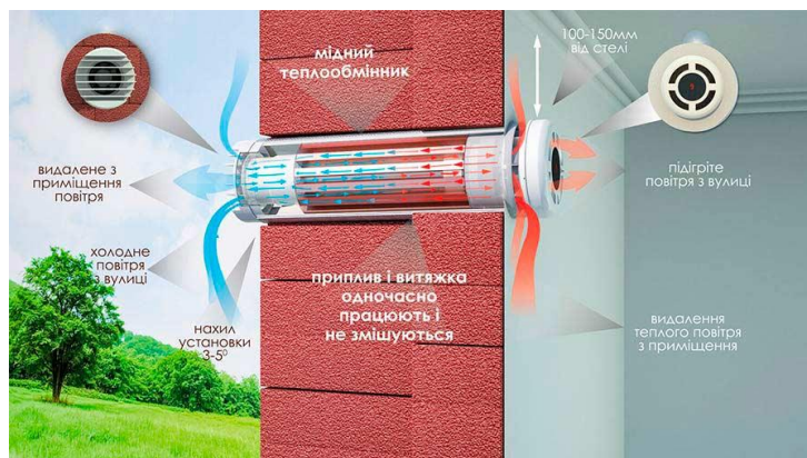
Рисунок 2.4 – Принцип роботи рекуператора
