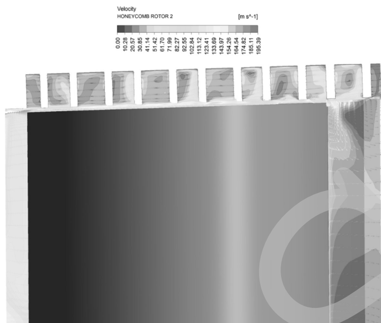
Рисунок 6.2 – Поле швидкостей для другого статора
