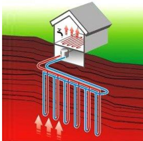
Рисунок 2.3 – Принципова схема розміщення теплового насосу
