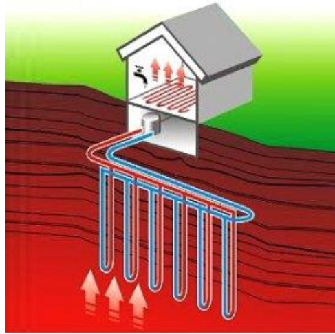
Рисунок 2.2 – Принципова схема розміщення теплового насосу [14]
