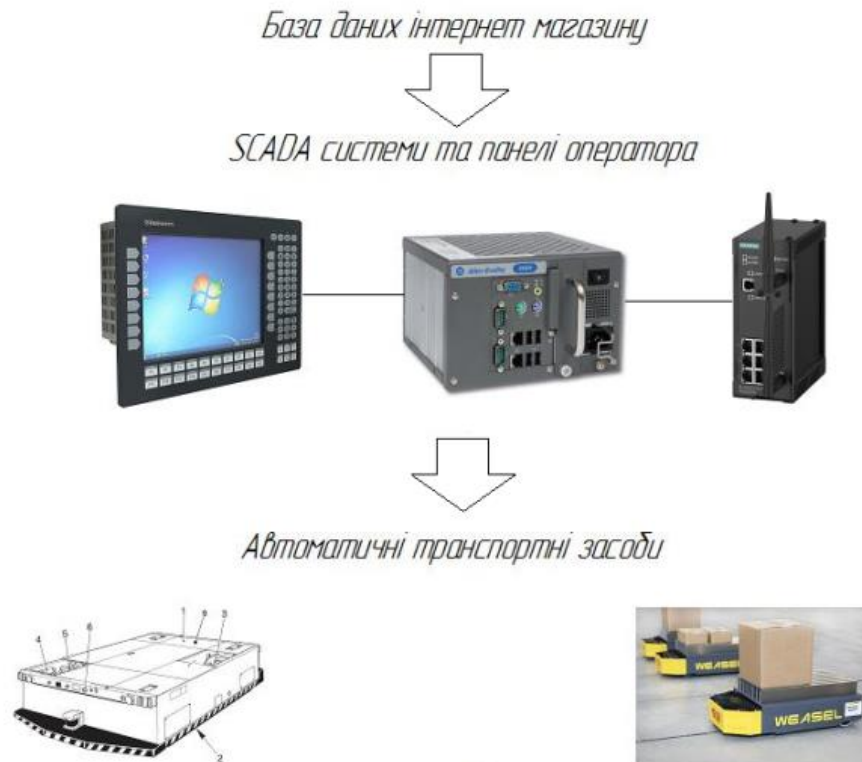
Рисунок 2.1 – Структура комп'ютерно-інтегрованої автоматизованої системи роботи складу інтернет-магазину
