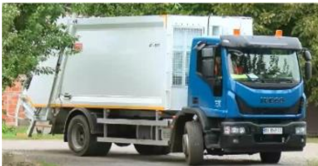
Рисунок 2.3 – Спеціально обладнаний транспортний засіб (смітєвоз) AT-5011 Iveco Eurocargo ML 180E25
