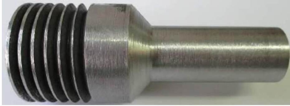
Малюнок 3.15 – Загальний вигляд експериментальних зразків сопел виготовлених з Ст 45
