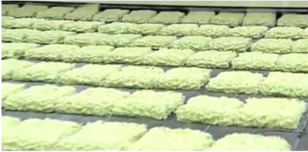
Рисунок 1.3 – Формування брикетів вермішелі швидкого приготування
