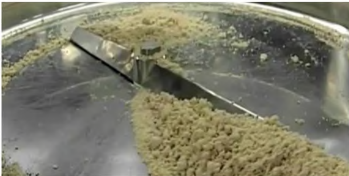
Рисунок 1.1 – Бункер замішування первинної сировини в тісто
