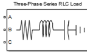
Рисунок 2.5 – Блок трифазного послідовного навантаження
