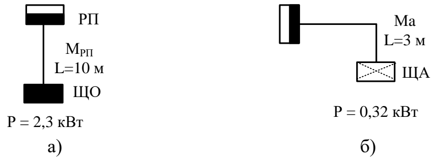
Рисунок 4.3 – Схема живлячої мережі а) робочого освітлення б) аварійного освітлення
