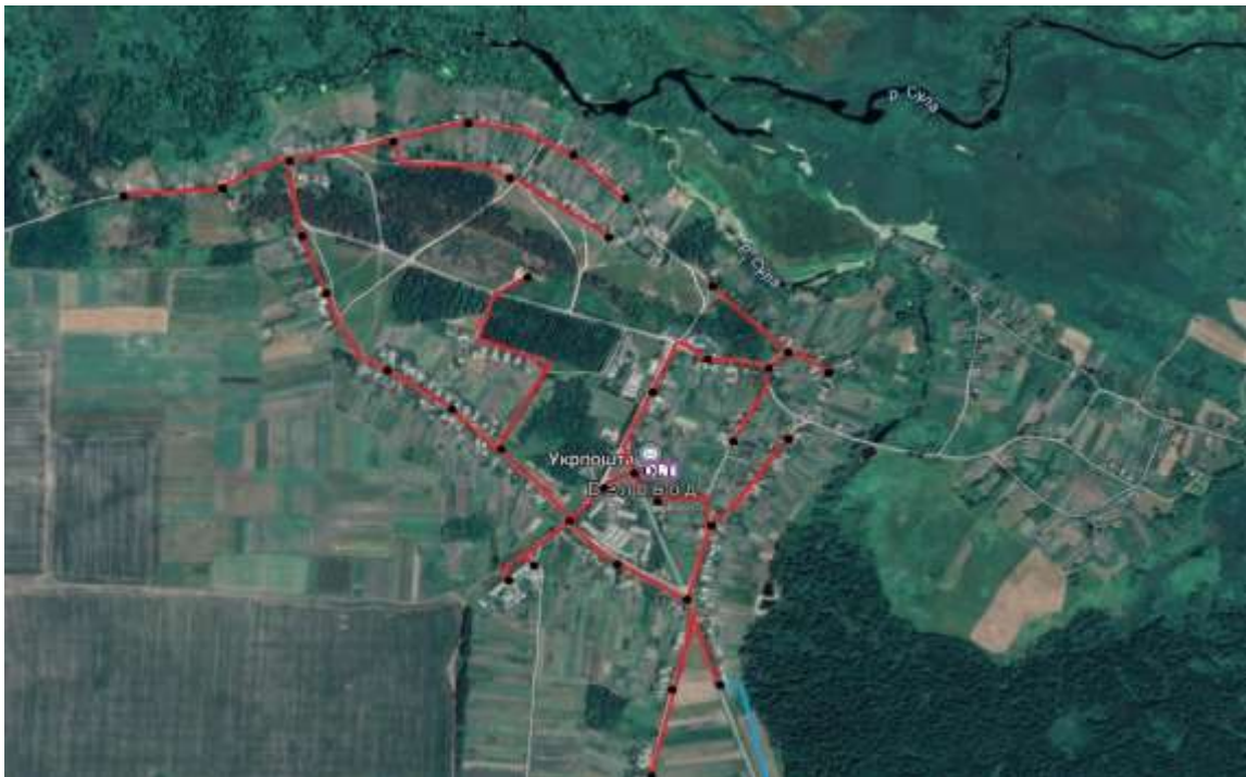
Рисунок 3.4 - Схема побудови кабельної магістралі та розміщення муфт
