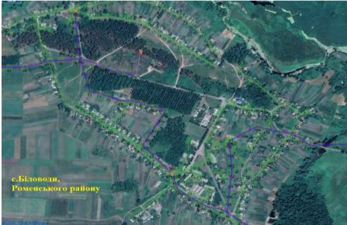
Рисунок 3.2 – Схема електричних магістралей з опорами ЛЕП -0,4 кВ та ЛЕП-10 кВ.
