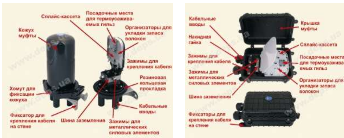
Рисунок 2.8 - Пример конструкции муфт с герметизацией вводов термофиксирующими трубками та за допомогою герметизуючої стрічки
