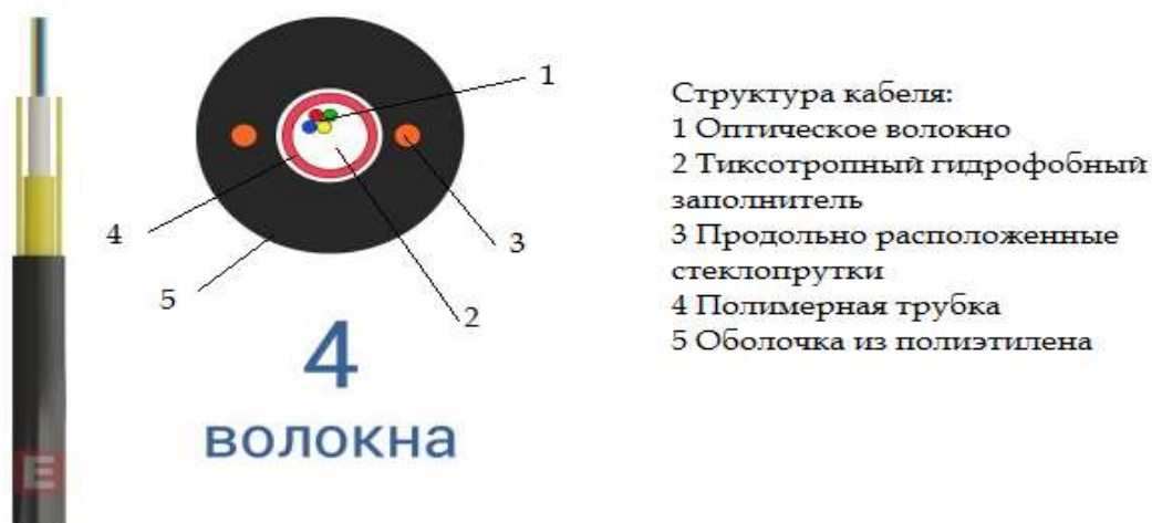
Рисунок 2.6 - Структура оптичного кабелю ОКТ-Д (1,0)П-4Е1, 4 волокна
