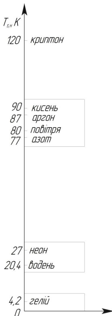
Рисунок 1.1 – Температурні рівні кипіння кріогенних речовин за атмосферного тиску
