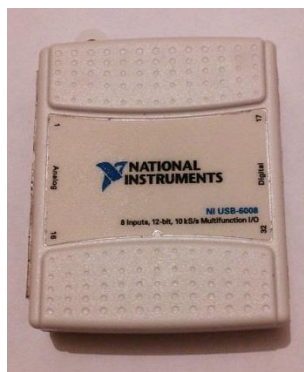
Рис. 1.1. Зовнішній вигляд контролера USB 6008
