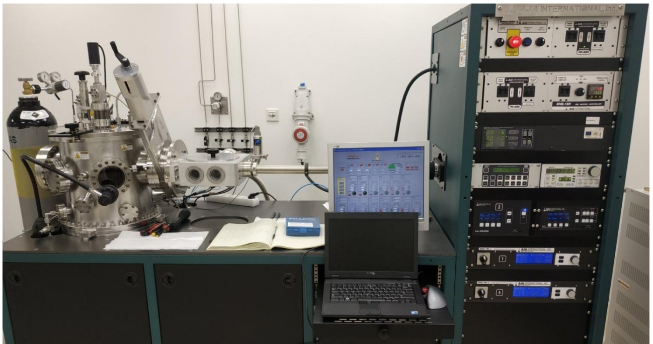
Рис. 2.2. Зовнішній вигляд високовакуумної установки АТС Orion для отримання зразків [64]
