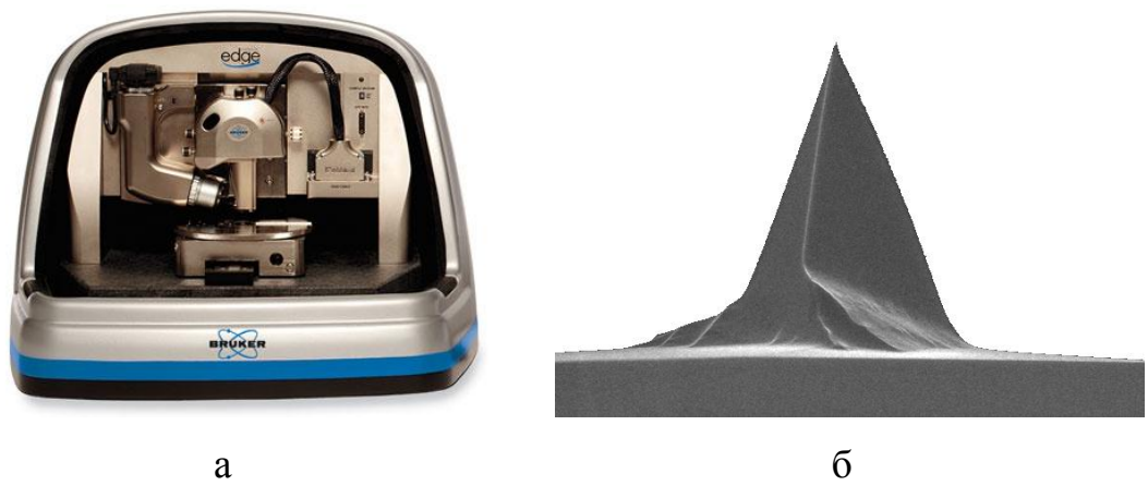
Рис. 2.4. Зовнішній вигляд АСМ Dimension Edge (а) та 3d модель зонда TESPA (б)
