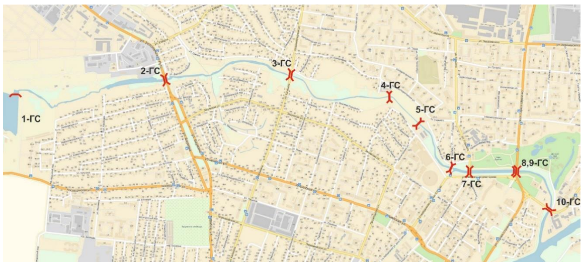
Рисунок 2.6 - Гідроспоруди на р. Сумка в межах м. Суми: 1-ГС – гребля Косівщинського водосховища; 2-ГС – автодорожній міст між вул. Баумана та
