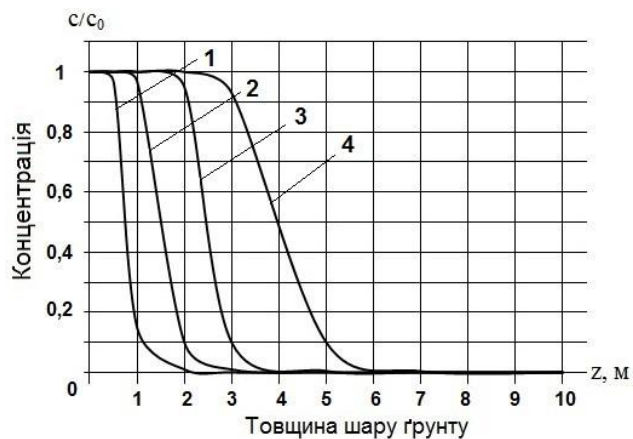
Рисунок 2 – Зміна концентрації забруднювальних речовин по товщині ґрунту в результаті фільтрації за різний час: 1 – 1 рік; 2 – 2 роки; 3 – 4 роки; 4 – 6 років
