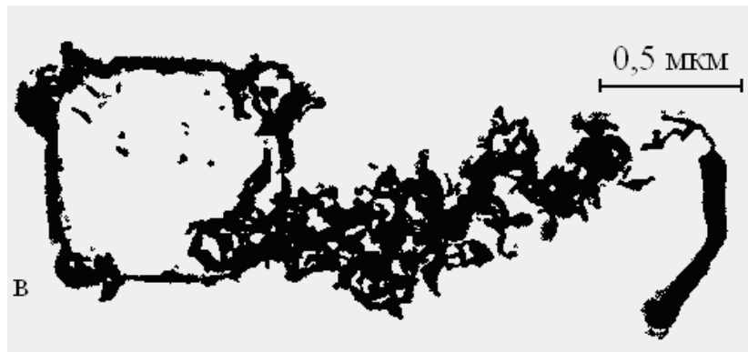
Рис. 3.20 ЕМФ проявленого одного МК AgHal після повторного хімічного проявлення (К.В. Чібісов). Місця проявлення розташовуються на вершинах куба мікрокристалу, де виходять вісі симетрії 3-го порядку [26, фото 7 а)], [123].
