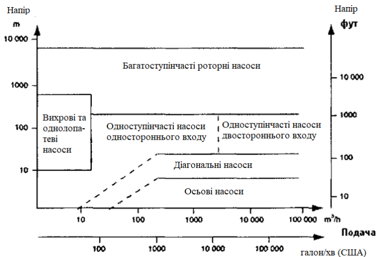
Рисунок 28 – Діаграма для вибору насосів динамічного типу під час перекачування чистої води
