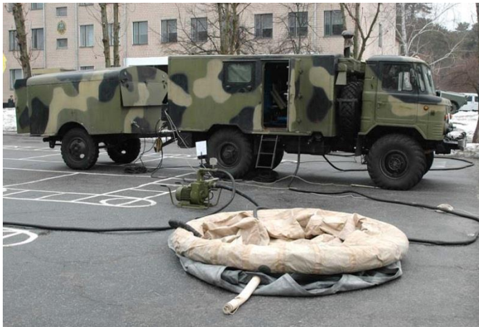
Рисунок 3.2 – Фільтрувальна станція МАФС-3
