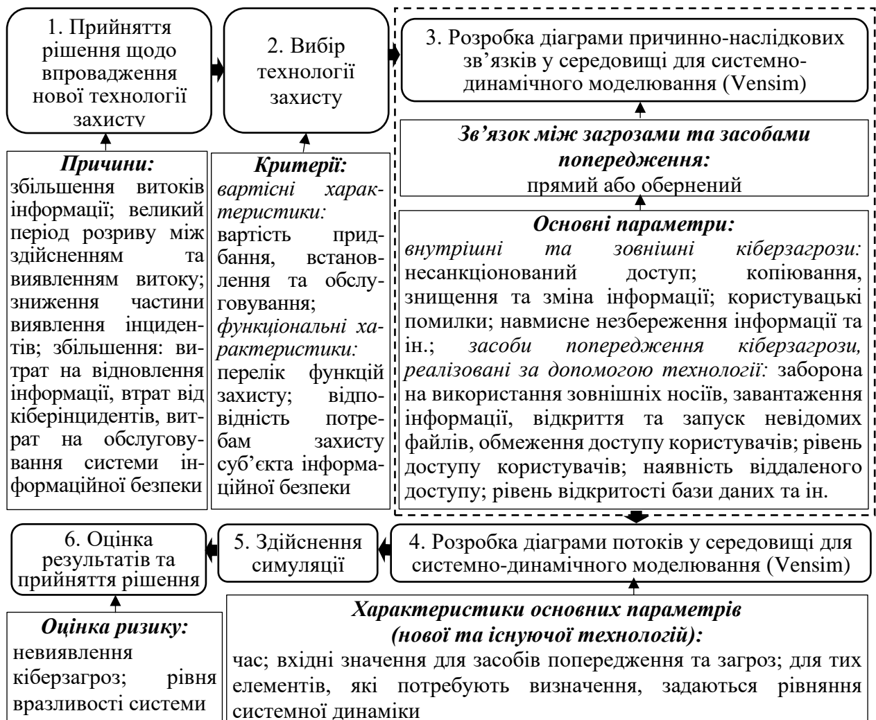
Рисунок 5.6 – Методологія системно-динамічного імітаційного моделювання для порівняння систем захисту інформації (складено авторкою)
