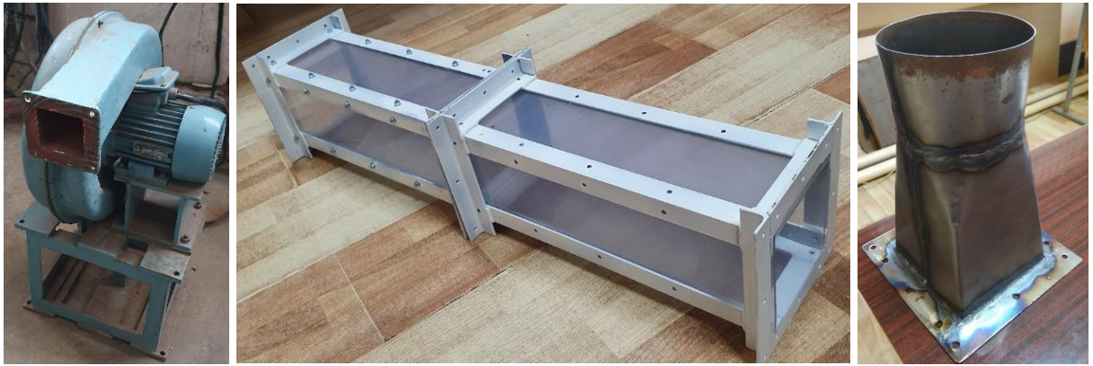
Рисунок 2.4 – Складові частини аеродинамічного каналу дослідно-експериментального стенду
