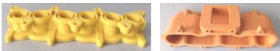
Рисунок 4.8 – Моделі, отримані за DLP-технологією: а) випалювальна ливарна модель; б) функціональна модель
