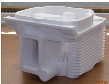
Рисунок 4.3 – Полістирольна модель (а) та алюмінієвий виливок головки циліндра ДВС (б)
