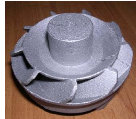
Рисунок 4.4 – Полістирольна модель: а) після «вироснування»; б) після інфільтрації; в) чавунний виливок
