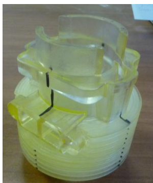
Рисунок 4.7 – Отримання виливків із використанням майстер-моделі: а) майстер-модель (SLA); б) воскова модель; в) вилівок
