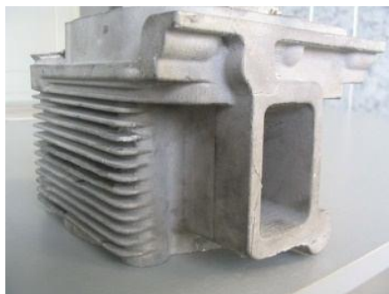
Рисунок 4.3 – Полістирольна модель (а) та алюмінієвий виливок головки циліндра ДВС (б)
