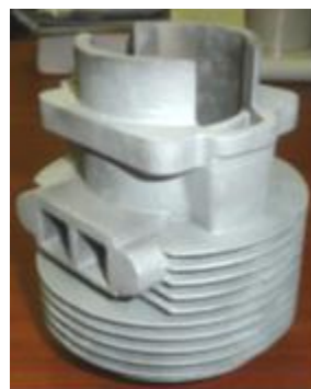
Рисунок 4.7 – Отримання виливків із використанням майстер-моделі: а) майстер-модель (SLA); б) воскова модель; в) вилівок
