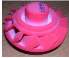
Рисунок 4.4 – Полістирольна модель: а) після «вироснування»; б) після інфільтрації; в) чавунний виливок
