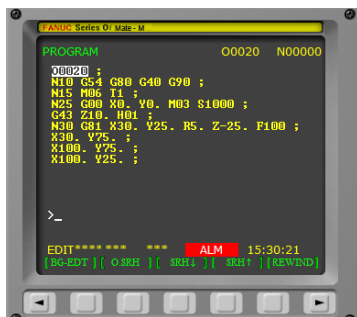
Рисунок 5.77 – Оброблення отворів відповідно до циклу G81:
