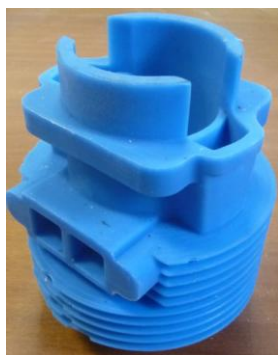
Рисунок 4.7 – Отримання виливків із використанням майстер-моделі: а) майстер-модель (SLA); б) воскова модель; в) вилівок
