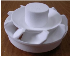
Рисунок 4.4 – Полістирольна модель: а) після «вироснування»; б) після інфільтрації; в) чавунний виливок
