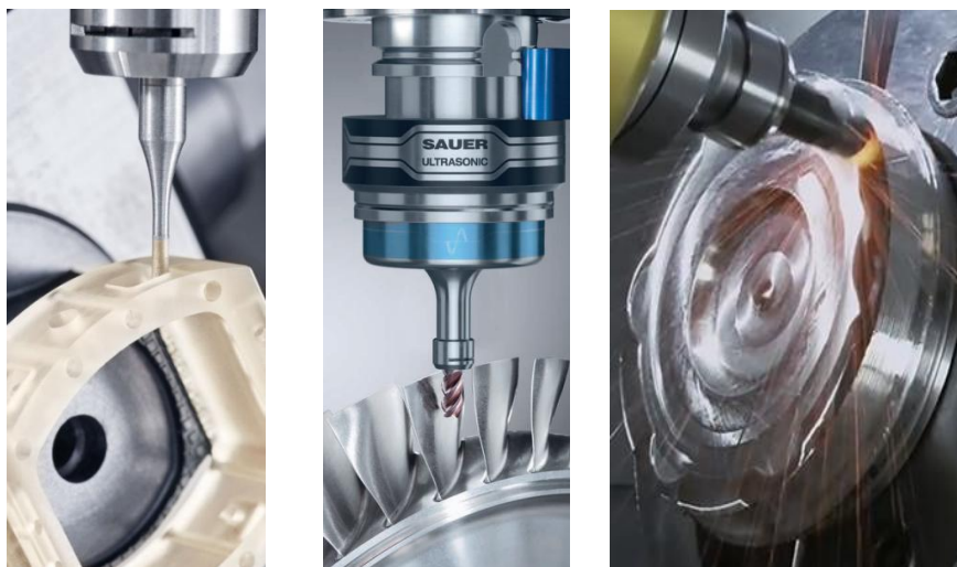
Рисунок 1.25 – Механічне оброблення з використанням ультразвукових коливань
