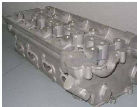
Рисунок 4.6 – Quick-cast модель із ливниковою системою (а) та алюмінієвий вилівок головки циліндрів (б)
